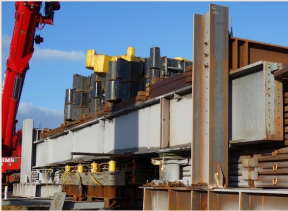
Belastningselementer kombineret med kraft- eller deformationsstyrede donkrafte
